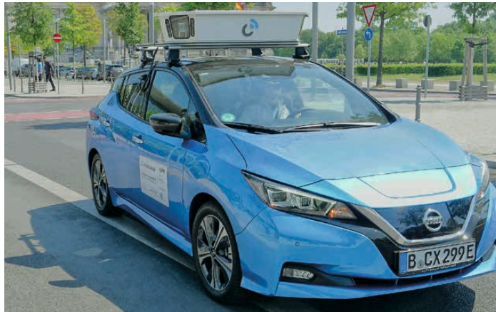
Spezialfahrzeuge haben in der Wiehre mit GPS, Laser und optischen Sensoren Daten über Parkplätze an Straßen gesammelt.
